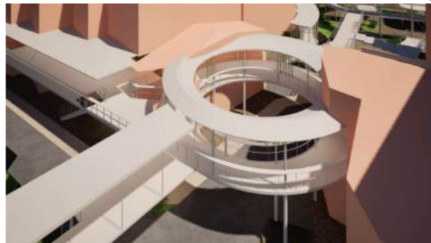
円環は、外側の縁と内側の円の中心をずらすことで通路の幅を変え、それぞれの場所の特性によって人々が自然と使い分けがなされるようになっている。
