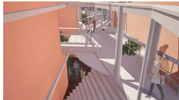
通路の一部の柱スパンを広く取り、楕円の屋根をかけることで1空中通路の下を広場化している
