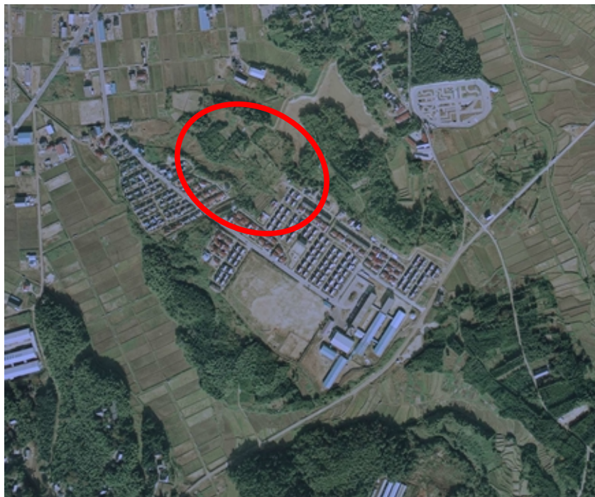
1975 年の航空写真(国土地理院, 空中写真閲覧サービス), 谷地形の埋め土であることがわかる
