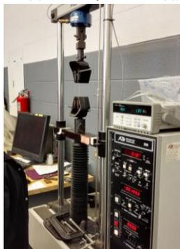
写真 2 引張試験の様子
