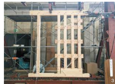
2 / 「壁1（カベワン）グランプリ」組み立ての様子 3 / 「壁1（カベワン）グランプリ」加力前 4 / 「壁1（カベワン）グランプリ」機械で加力
