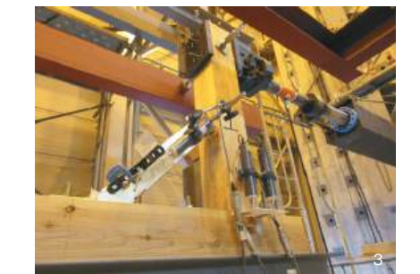
3/伝統構法で使える制震ダンパーを、企業と共同開発している
