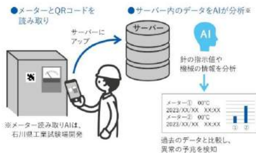
システム概要図（スマホを活用したスマート検針サービス化の技術開発）
