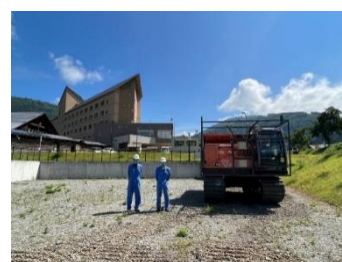
遠隔操縦で対象とした重機 （16トンサイズ）
