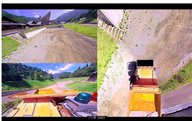
全方位映像による重機の周囲確認が可能
