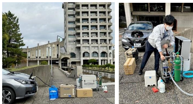
EV車を電源とし、浄水装置で作業を行う職員
