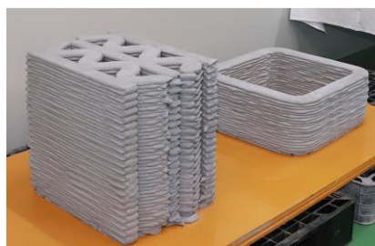
ロボットアームからセメント材料を吐出し積層しながら部材を製作する。
