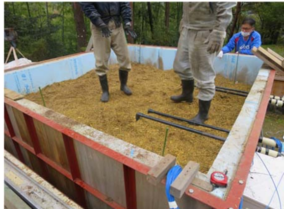
天池採熱実験装置への竹チップの投入作業
