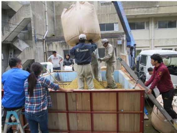
天池採熱実験装置への竹チップの投入作業
