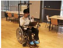
脳波で制御するロボット車いすの実証実験。利用者は頭で目的地を指定するだけで、車いすが自動的に移動するもので、病院での実証実験も行われている。
