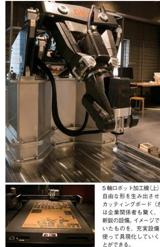
5軸ロボット加工機(上)や、自由な形を生み出させるカッティングボード(左)は企業関係者も驚く、最新鋭の設備。イメージで描いたものを、充実設備を使って具現化していくことができる。
